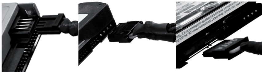
Connettore FDD (immagine a sinistra), connettore MOLEX (immagine centrale) e connettore S-ATA (immagine a destra)
