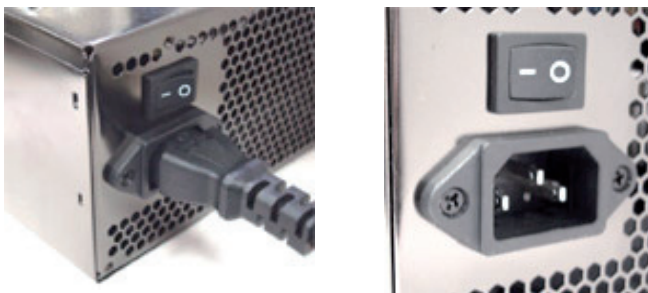
Virtajohdon liitin tehokytkimellä. "I" ilmoittaa laitteen olevan päällä, "O" pois päältä.
