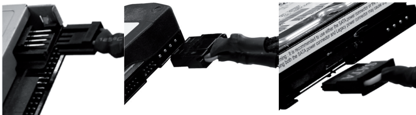
Connecteur FDD (image de gauche), connecteur MOLEX (image du milieu) et connecteur S-ATA (image de droite)
