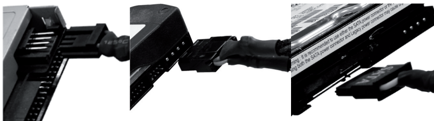
Conector FDD (poza din stânga), conector MOLEX (poza din centru) și conector S-ATA (poza din dreapta).
