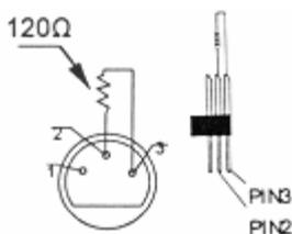
Es empfiehlt sich eine DMX-Terminierung wenn das DMX-Kabel eine große Distanz überbrücken muss oder in einer Umgebung mit vielem elektrischen Geräusch verwendet wird (z.B. Diskothek). Die Terminierung verhindert Korruption des digitalen Kontrollsignals durch elektrisches Geräusch. Die DMX-Terminierung ist nur ein XLR-Stecker mit einem Widerstand von 120Ω zwischen Pol 2 und Pol 3. Dieser XLR-Stecker wird dann in den XLR-Ausgang am letzten Gerät gesteckt. Siehe Abbildung links.
