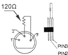
Se recomienda una terminación DMX si el cable DMX debe cubrir una gran distancia o si se usa en un medio ambiente con mucho ruido eléctrico (p.ej. una discoteca). La terminación impide que el ruido eléctrico corrompa la señal de control numérico. La terminación DMX no es más que un conector XLR con una resistencia de 120Ω de polo 2 a polo 3. Este conector XLR está conectado a la salida XLR del último aparato de la serie. Véase la figura a la izquierda.
