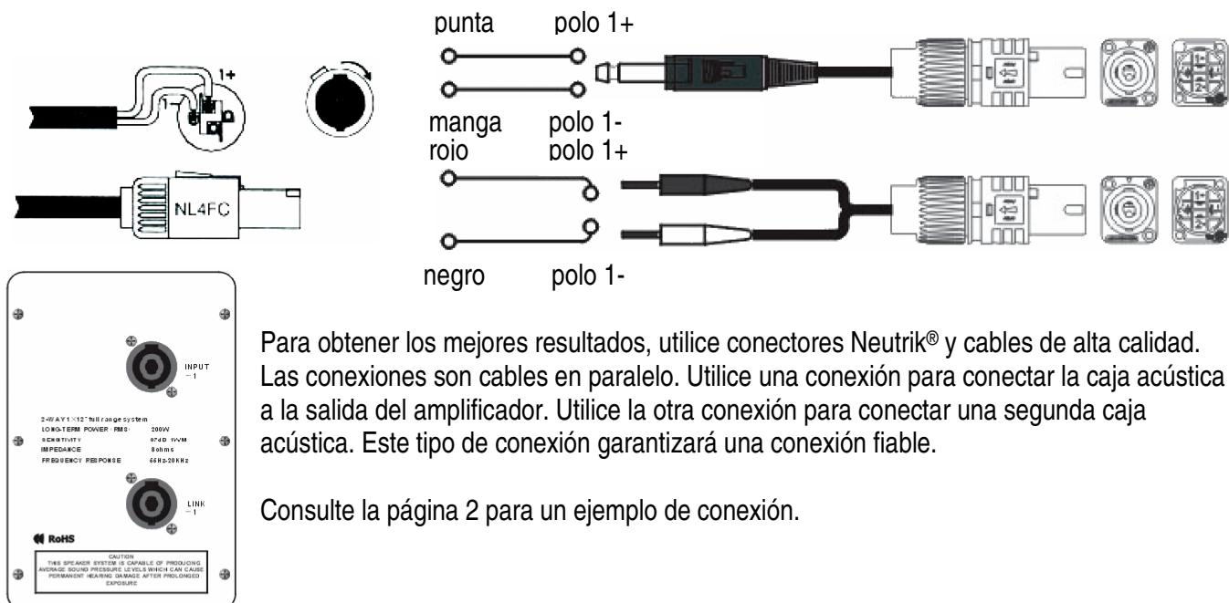
Para obtener los mejores resultados, utilice conectores Neutrik® y cables de alta calidad. Las conexiones son cables en paralelo. Utilice una conexión para conectar la caja acústica a la salida del amplificador. Utilice la otra conexión para conectar una segunda caja acústica. Este tipo de conexión garantizará una conexión fiable.
