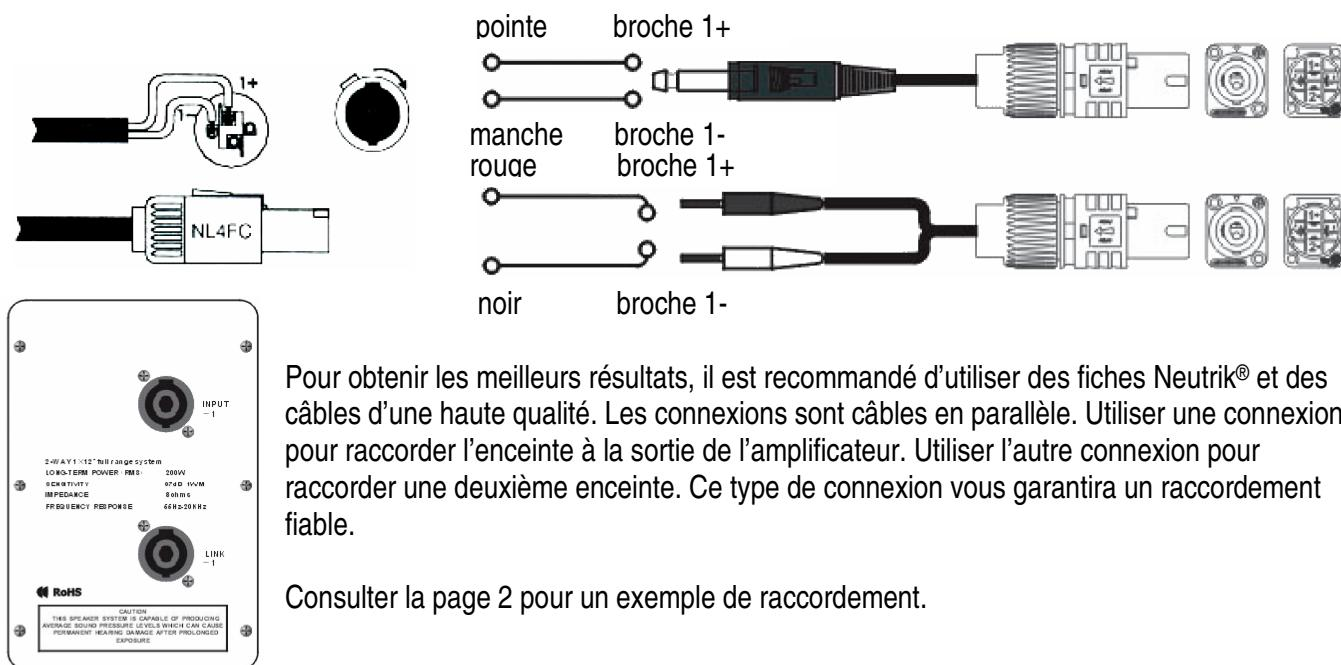
Pour obtenir les meilleurs résultats, il est recommandé d'utiliser des fiches Neutrik® et des câbles d'une haute qualité. Les connexions sont câbles en parallèle. Utiliser une connexion pour raccorder l'enceinte à la sortie de l'amplificateur. Utiliser l'autre connexion pour raccorder une deuxième enceinte. Ce type de connexion vous garantira un raccordement fiable.
