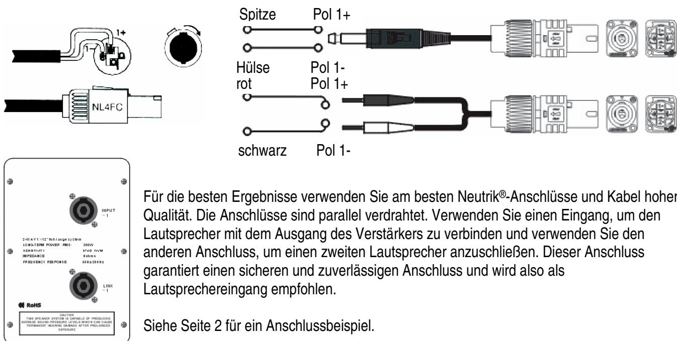
Für die besten Ergebnisse verwenden Sie am besten Neutrik®-Anschlüsse und Kabel hoher Qualität. Die Anschlüsse sind parallel verdrahtet. Verwenden Sie einen Eingang, um den Lautsprecher mit dem Ausgang des Verstärkers zu verbinden und verwenden Sie den anderen Anschluss, um einen zweiten Lautsprecher anzuschließen. Dieser Anschluss garantiert einen sicheren und zuverlässigen Anschluss und wird also als Lautsprechereingang empfohlen.
