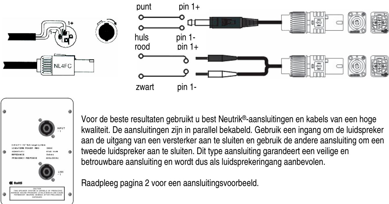
Voor de beste resultaten gebruikt u best Neutrik®-aansluitingen en kabels van een hoge kwaliteit. De aansluitingen zijn in parallel bekabeld. Gebruik een ingang om de luidspreker aan de uitgang van een versterker aan te sluiten en gebruik de andere aansluiting om een tweede luidspreker aan te sluiten. Dit type aansluiting garandeert een veilige en betrouwbare aansluiting en wordt dus als luidsprekeringang aanbevolen.
